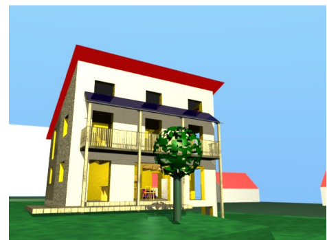
Eine Simulation zeigt die Verschattung durch Balkon und Solaranlage in den verschiedenen Jahreszeiten.
